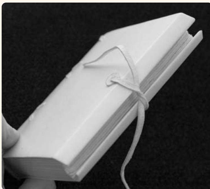
Figura 3. Modelo de un encuadernado típico en vitela flexible. Modelo de libro preparado por la autora.
